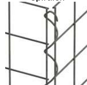
einfaches eindrehen per Hand
